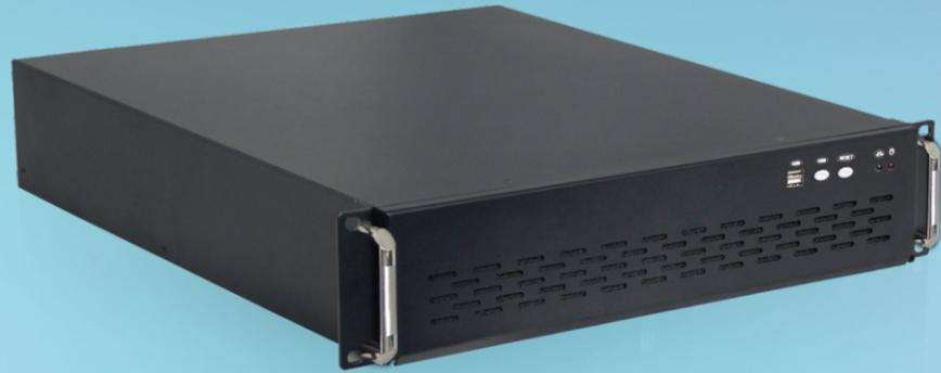
标准2U、19英寸可上架型工业机箱，机箱带安全锁保护，整机尺寸482mm×500mm×88mm（W×D×H），兼容2个或4个2.5/3.5寸硬盘（由电源决定），支持PCI、PCI-E 16X、PCI-E 4X槽位扩展（依扩展板决定）。前面板：2×USB、开关按钮、重启按钮、电源指示灯、硬盘指示灯，后面板：依主板板载接口外露。电源可选标准ATX电源和2U工业电源，AC 110V ~ 220V电源输入。整机抗震性强、兼容性高，维护、拆卸简单。箱盖带安全锁，整机内部走线简洁。
