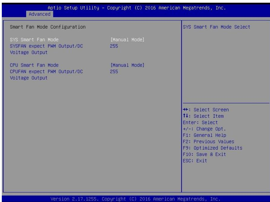
智能风扇模式配置选项，可以选择 manual mode, thermal cruise mode, speed cruise mode 三种模式。手动模式 (Manual mode) 设定固定值运转，与环境无关。温度巡航模式 (Thermal Cruise mode) 风扇测 CPU 温度，根据温度自动调节转速。温度越高转速越快。速度巡航模式 (Speed Cruise mode) 风扇测风速，根据风速自动调节转速。速度越低转速越快；
